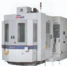
Opracování skříní převodovek na obráběcích centrech Daewoo ACE VC 500 a ACE HP 500
